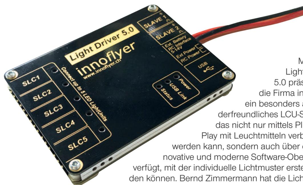
Mit dem Light Driver 5.0 präsentiert die Firma innoflyer ein besonders anwenderfreundliches LCU-System, das nicht nur mittels Plug and Play mit Leuchtmitteln verbunden werden kann, sondern auch über eine innovative und moderne Software-Oberfläche verfügt, mit der individuelle Lichtmuster erstellt werden können. Bernd Zimmermann hat die Lichtsteuerung der neuesten Generation für uns getestet.
