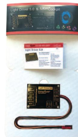
Der Inhalt der Verpackung: Das Light Driver 5.0-Modul sowie ein Quick-Start Guide. Der rote JST-Stecker ist für den Spannungsanschluss von 5 bis 14 V, der JR-Servostecker zum Verbinden mit einem Empfänger oder für den Slave-Betrieb.
