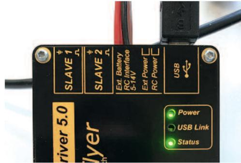
Die Anschlüsse für USB/PC, Slave-Betrieb, Spannungsversorgung, Empfängeranschluss sowie der Jumper für die Auswahl der Spannungsversorgung.
