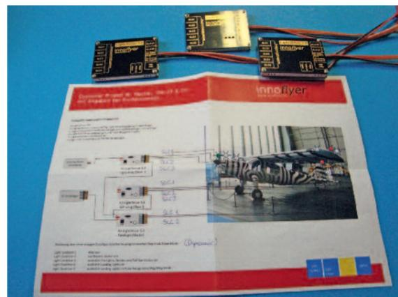
Im sogenannten »customer project plan« entwerfen die Spezialisten von InnoFlyer einen Vorschlag zur Beleuchtung des Modells mit den unterschiedlichen Lichtquellen. Der Vorschlag kann variiert und die im Werk vorgenommene Programmierung später auch komplett geändert werden.
