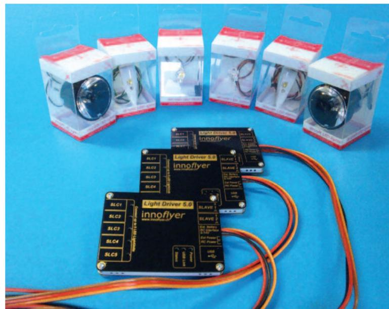
Die neuen LightDriver als programmierbare Steuersysteme der Beleuchtung ermöglichen den Anschluss mehrerer Untersysteme. An jedem können bis zu fünf verschiedene Lichtquellen angeschlossen werden. Bei der Firma InnoFlyer werden alle Lichtquellen, die in einem großen Flugzeug vorkommen auch als Miniaturen als Strobes, Landescheinwerfer, Positions- und Navigationslichter angeboten.
