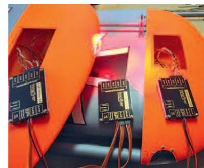
Der Vorteil der modularen Erweiterungsoption ist, dass man die zusätzlich angeschlossenen LD dort einbauen kann, wo die Lichtquellen später auch leuchten sollen. Da die Slaves nur mit einem dreiadrigen Servokabel mit dem Master verbunden sind, erspart man sich aufwendige Kabelbäume.
